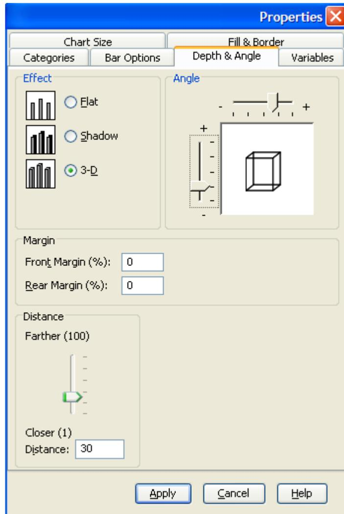
في هذه النافذة يتم اختيار **Depth & Angle** ثم اختيار **3-D** مع تعديل الزاوية **Angle** ثم الضغط على **Apply** نحصل على الشكل في صورته التالية:
